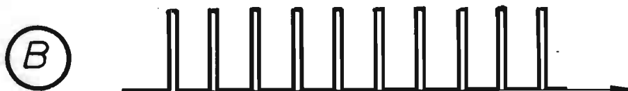
Fig. 6 - Nel punto B del circuito del trasmettitore è presente un segnale di bassa frequenza a 400 Hz circa, qui espresso analiticamente tramite diagramma.
